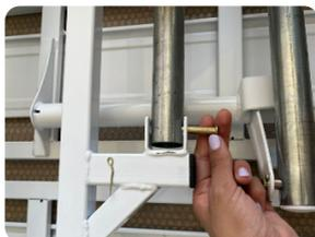
*Nota: Caso as manivelas tenham sido removidas para a instalação do kit elétrico, será necessário realocar o tubo da manivela como ilustrado anteriormente para que as manivelas voltem a funcionar corretamente.*
