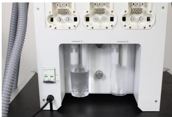
5. Após o término da drenagem remova o recipiente girando no sentido horário e descarte a água que foi drenada no filtro localizado na parte posterior do equipamento.
