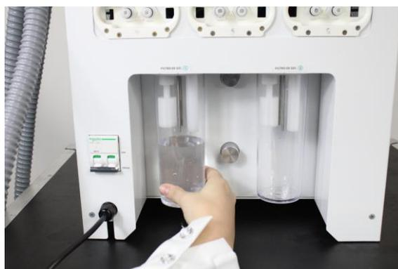
6. Após descartar a água conecte o filtro novamente girando no sentido horário. Rosqueie o filtro até o final para evitar vazamento de vácuo no sistema e mal funcionamento da sucção dos aplicadores.
