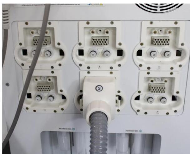
**5)** Conecte o cabo do aplicador de ultrassom de baixa frequência na saída do equipamento, localizada em sua parte posterior. Para realizar o encaixe, mantenha o conector do aplicador com o adesivo de marcações de referência
