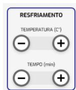
Resfriamento: Indica que o equipamento está realizando a operação de resfriamento;
