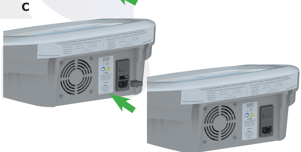
Figura 22. A, Removendo a tampa protetora e a gaveta de fusíveis; B, substituindo os fusíveis de proteção; e C, reposicionando a gaveta de fusíveis.
