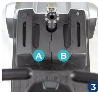
**PASSO 4:** Puxe a alavanca de rotação do assento e coloque-o sobre o tubo previamente instalado na estrutura principal. Gire o assento suavemente de um lado para outro até encaixá-lo.
